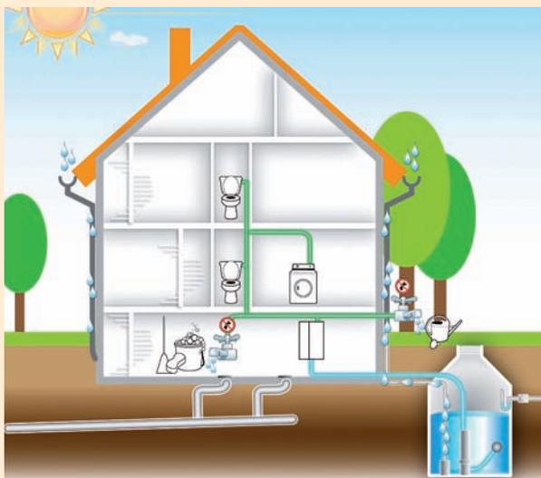
**Système de filtration des eaux grises pour injection dans le réseau des toilettes, de la machine à laver et du jardin**
