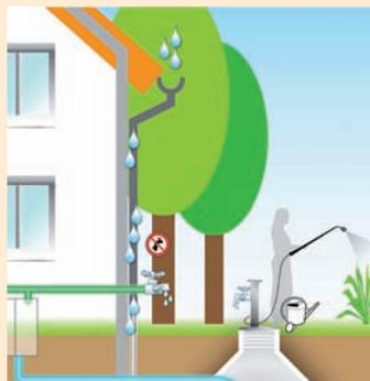
**Système de récupération des eaux de pluie avec injection dans un réseau spécifique pour les toilettes, la machine à laver et le jardin**
